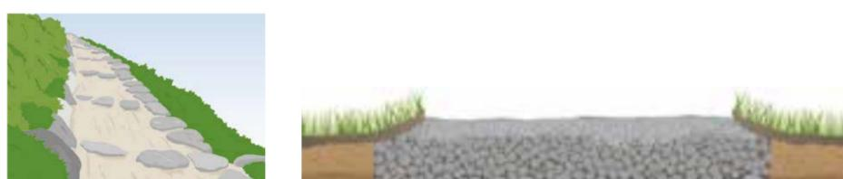
Figur 3 – Illustrasjon på tiltak, spaltar og oppheva stikonstruksjon, for å redusere erosjon, frå Merkehåndboka.
